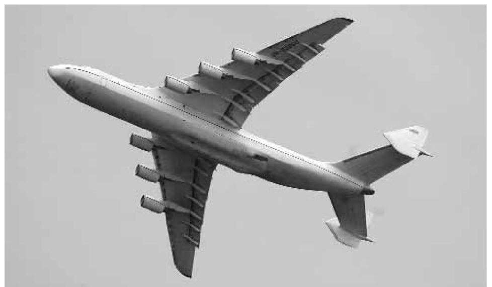
Самый крупный в мире самолет Ан-225 «Мрия» с максимальной грузоподъемностью 250 т в настоящее время планируется к использованию в качестве платформы для воздушного старта ракеты «Зенит». Комбинация, получившая название «Свитязь», сможет вывести на орбиту спутник весом до 4500 кг.
